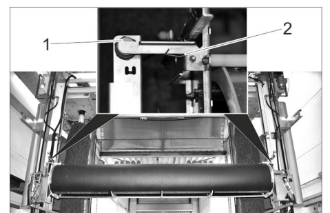
Bild 8 1 Endschalter Sicherheitsschalter Hochdruck-Dachbalken 2 Feder
